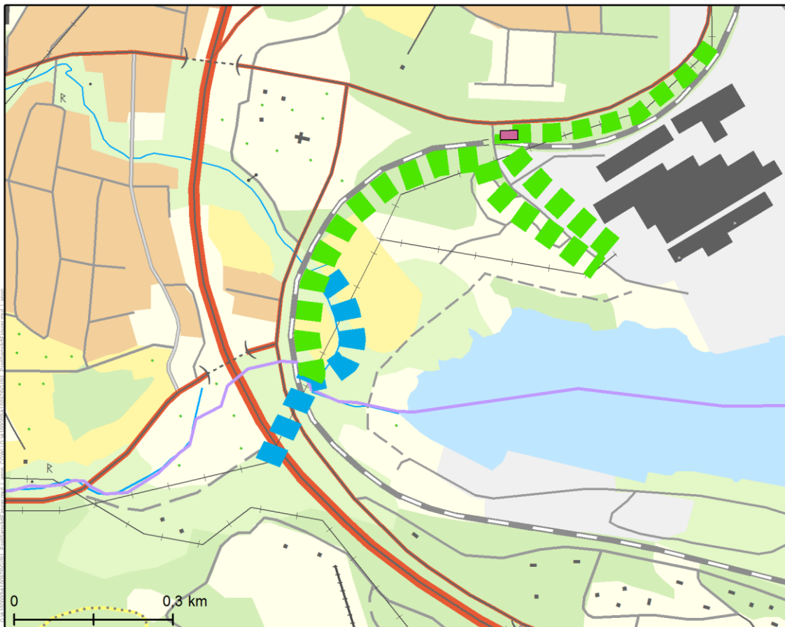
Figur 2: Huvudalternativen för de två ledningarna (gröna streckade stråk), förslag till alternativ utformning och sträckning (blått streckat stråk) samt ställverk (röd rektangel).
