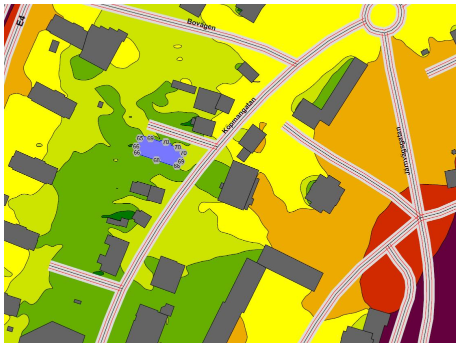
Bild 4. Ljudutredningskarta 2 m över mark och högsta ljudnivå intill fasad på ett exempelhus (för prognosår 2035).
