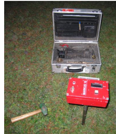
Figur 8 Instrument för radonmätning
