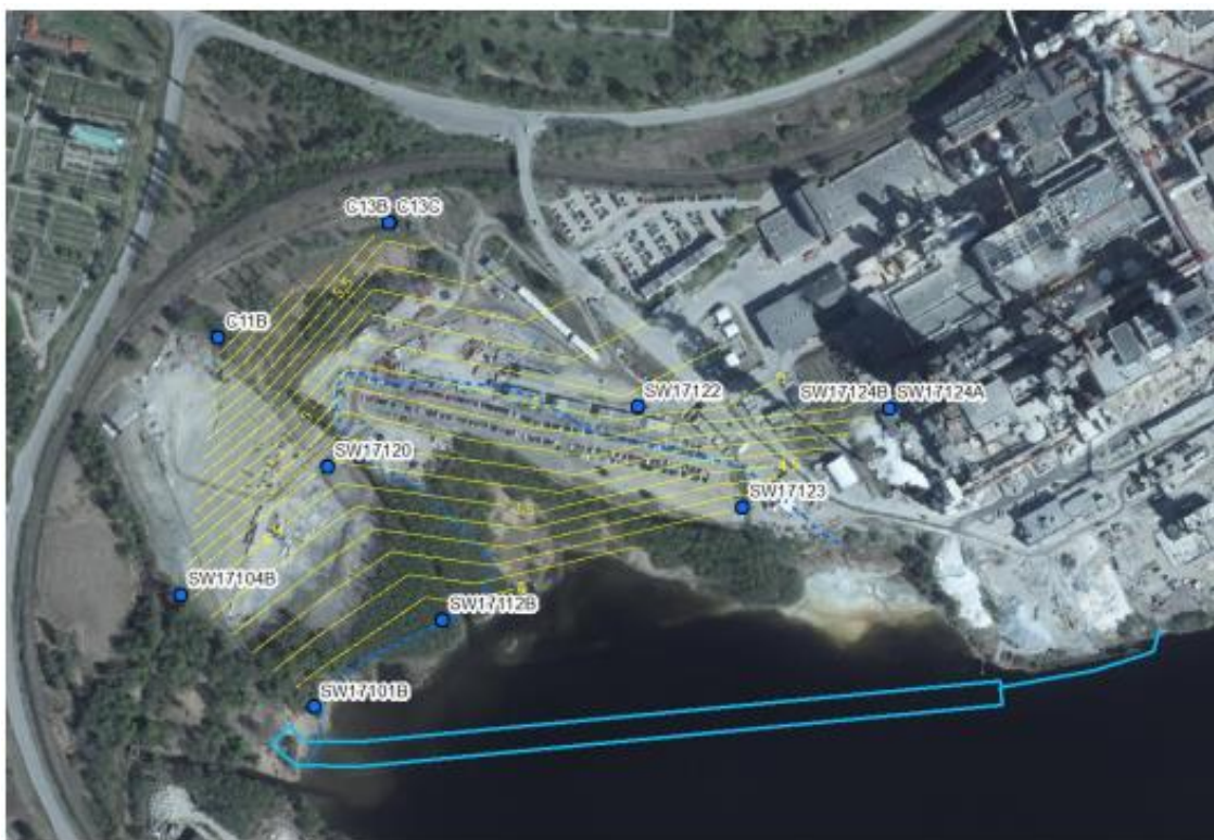
Figur 8.1. Interpolerade grundvattennivåer från SWECOs beskrivning)
